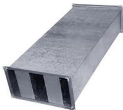
Пластинчатые шумоглушители RSA предназначены для поглощения аэродинамического шума в прямоугольных воздуховодах. Шумоглушитель устанавливается в направлении движения воздуха, указанном на чертеже стрелкой. Для достижения максимальной эффективности шумопоглощения рекомендуется предусмотреть перед шумоглушителем прямолинейный участок длиной не менее 1 м.
