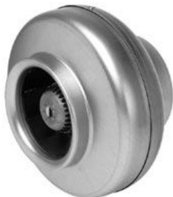
Канальные вентиляторы СК имеют типоразмеры от 100 до 315 мм и предназначены для установки в круглых каналах. Все вентиляторы оборудованы асинхронными двигателями с внешним ротором и уплотнёнными подшипниками, что увеличивает срок их службы. Корпус изготавливается из гальванизированной стали. Степень защиты электродвигателя IP 44, клеммной колодки - IP 54.
