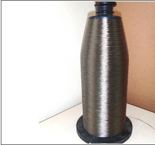
Базальтовая нить — это продукт плавления базальтовых пород с последующей формовкой их в нить. Материал негорючий, инертный, в том числе и индифферентный к ультрафиолету, чего не скажешь о большинстве современных материалов. Применение полотен на основе базальтовых нитей нашло широкое применение в строительстве, автомобиле- и судостроении. Используют его как армирующую сетку, защитный экран, противопожарную защиту.
