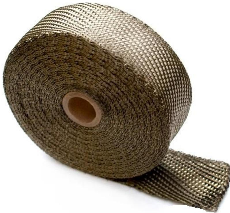
Базальтовая лента представляет собой рулон негорючей материи из минерального волокна. По структуре мягкая и пластичная, она идеально подходит для заделки различных швов, щелей, небольших технологических отверстий. Чаще всего изделие применяется для изоляции смежных помещений в зданиях и сооружениях. После укладки ленты в сквозную щель
