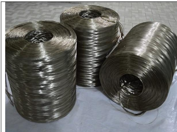
Производство базальтового ровинга происходит путем плавления базальтовой породы в плавильной печи, выработкой расплава через фильерный питатель, вытяжкой непрерывных волокон в комплексную нить, нанесением замасливателя, намоткой комплексной нити, сушкой паковок комплексной нити, трощением комплексной нити в ровинг.
